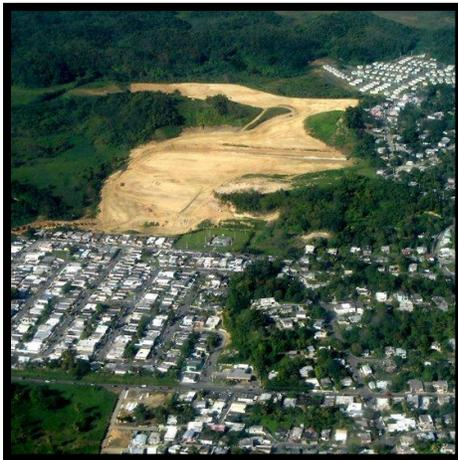
Foto que ilustra una construcción típica de la Isla, inicialmente se remueve la capa vegetal y se reemplaza posteriormente por materiales con poca o ninguna permeabilidad y de albedos inapropiados. Como resultado se obtienen aumentos en las temperaturas ambientales y en la cantidad de escorrentías.
